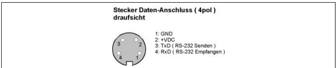
Bild 3: Anschlussbelegung der RS-232 Schnittstelle
