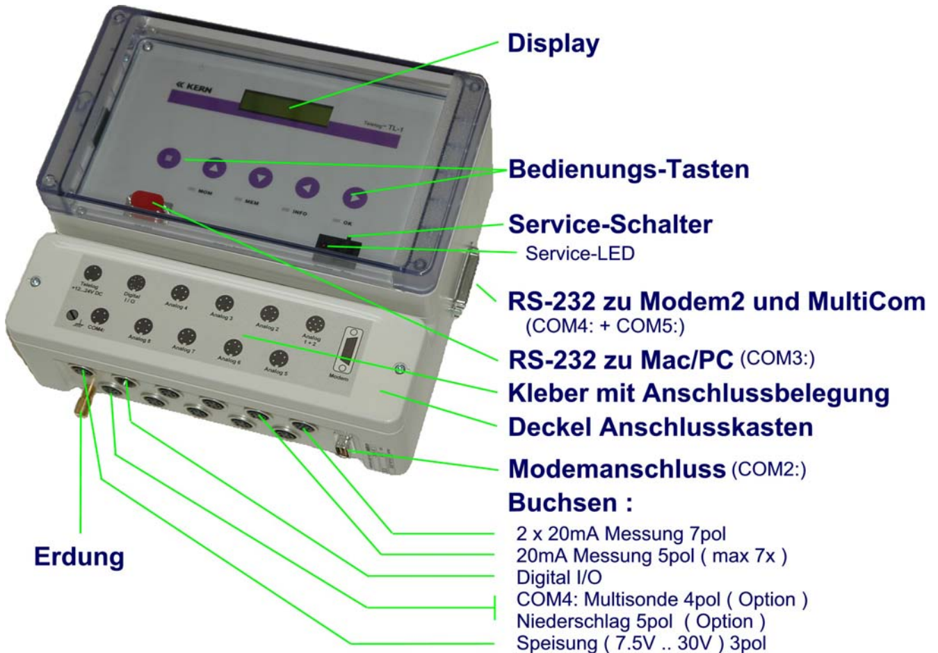
Bild 1: Bedienungselemente des Telelog™ TL-1
